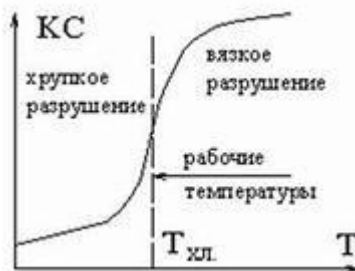
Рис.3 График порога хладноломкости
