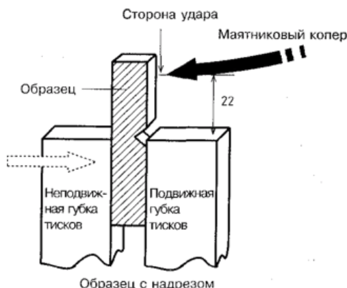
Рисунок 2. Схема испытания по методу Изода
