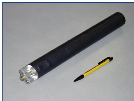
Рис. 1.6. Ксеноновый гамма-детектор с рабочим объемом 0,2 литра
