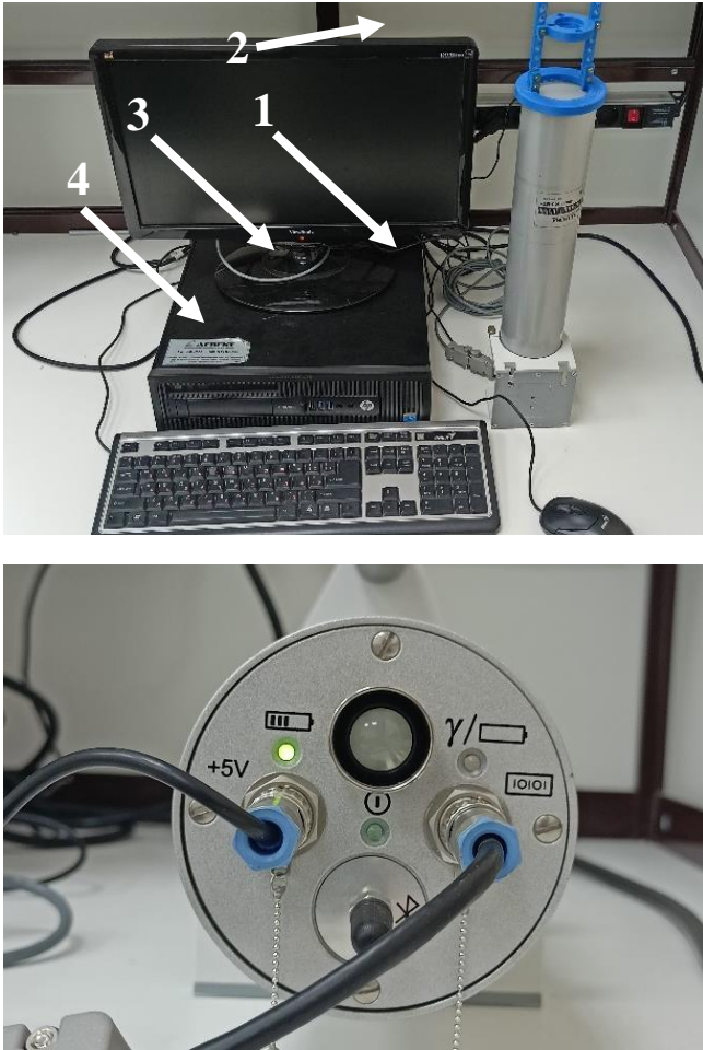
Рис. 7.2. Фотография экспериментального стенда (сверху): 1 – спектрометр Гамма-IC/NB1-0; 2 – место установки источников гамма-излучения; 3 – ПК с программным обеспечением SpectraLine, Nuclide Master и EtEdit; 4 – электронный ключ безопасности. Снизу – торец спектрометра с кнопкой включения, разъемами для подключения ПК и адаптера питания
