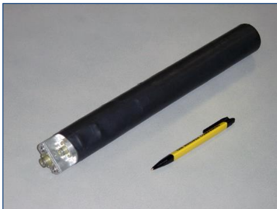
Рис. 1.6. Ксеноновый гамма-детектор с рабочим объемом 0,2 литра
